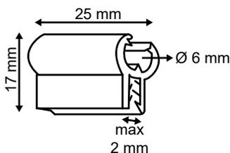
Ø Draht: 6 mm - Maximale Dicke der Werbung: 2 mm
