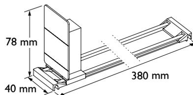
*Mittlere Schubkraft: 6 Newton - ohne Rausfallschutz*
