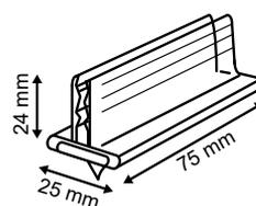
Grundfläche 25 mm - Maximale Dicke der Werbung: 5 mm
